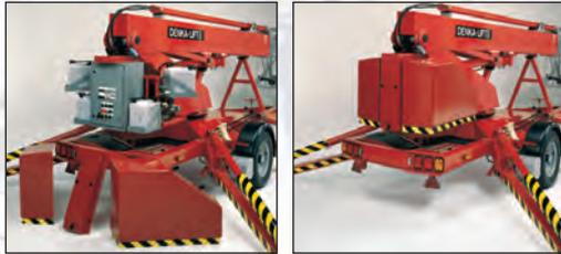
Das funktionelle Design der Abdeckungen für die Batterien sowie für die hydraulischen und elektrischen Kontrolleinrichtungen erleichtern und rationalisieren Service- und Wartungsarbeiten.
